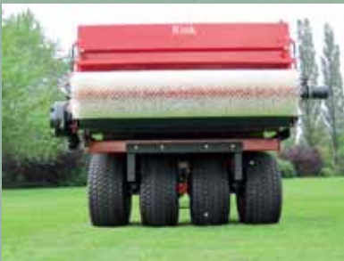
Rink 1520 可选配4个较小的行走轮，以降低设备的重心，便于装沙。
