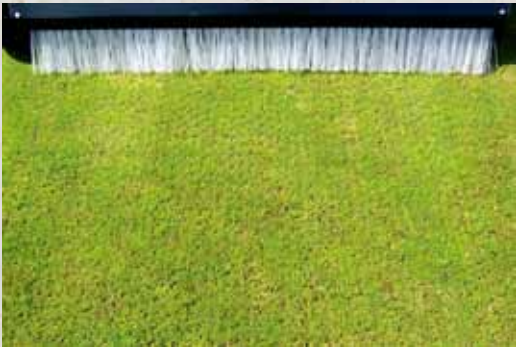
后刷可以帮助种子落到孔中，以保证好的发芽率
