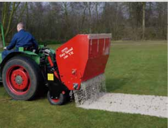
Easy-Spread 2000TR 七个行走轮承载重量。
